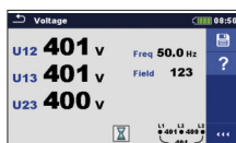
Mesure de tension (triphasé)
